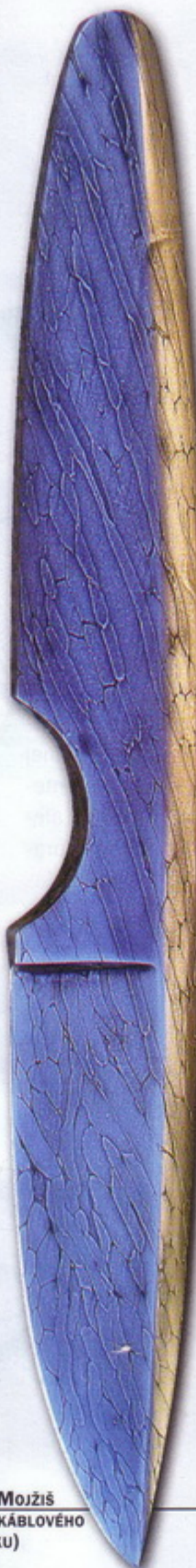
JÚLIUS MOJŽIŠ (REŤAZOVÝ DAMASK Z MOTOC. PREVODU)
